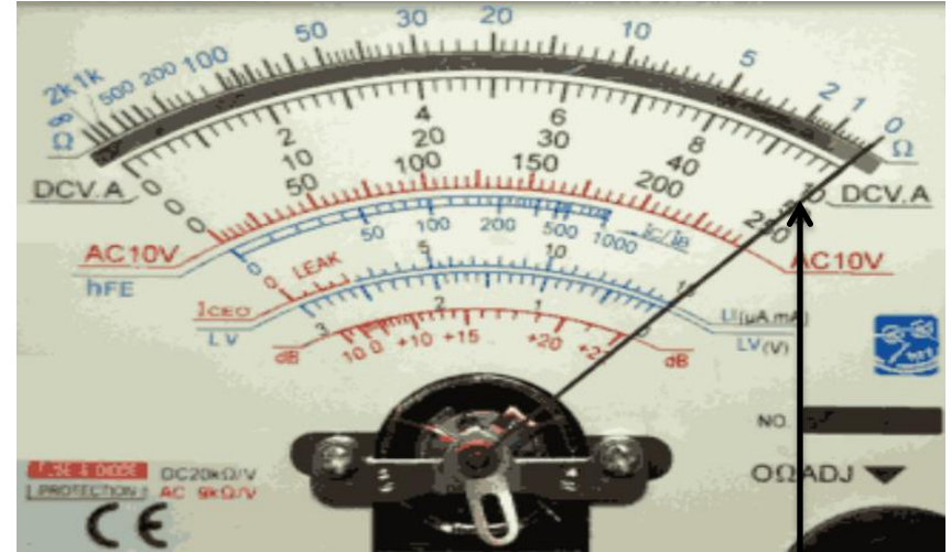
දර්ශකය \Omega පරිමාණයේ ශුන්‍යය ලකුණ තෙක් පැමිණෙන බව තහවුරු කර ගැනීම
