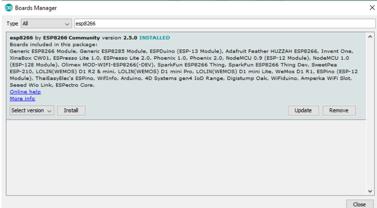
පියවර 11- පුවරු කළමනාකාර දිගුව ස්ථාපනය කිරීමෙන් පසුව, නැවත Tools -> Board (...) වෙත ගොස් NodeMCU 1.0 (ESP-12E module) තෝරා ගන්න
